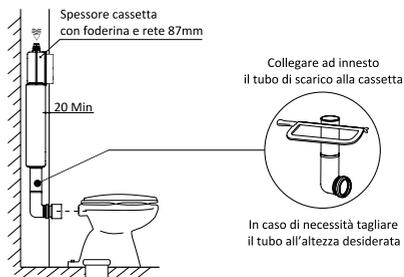
**Posizionamento e fissaggio della cassetta alla muratura**
